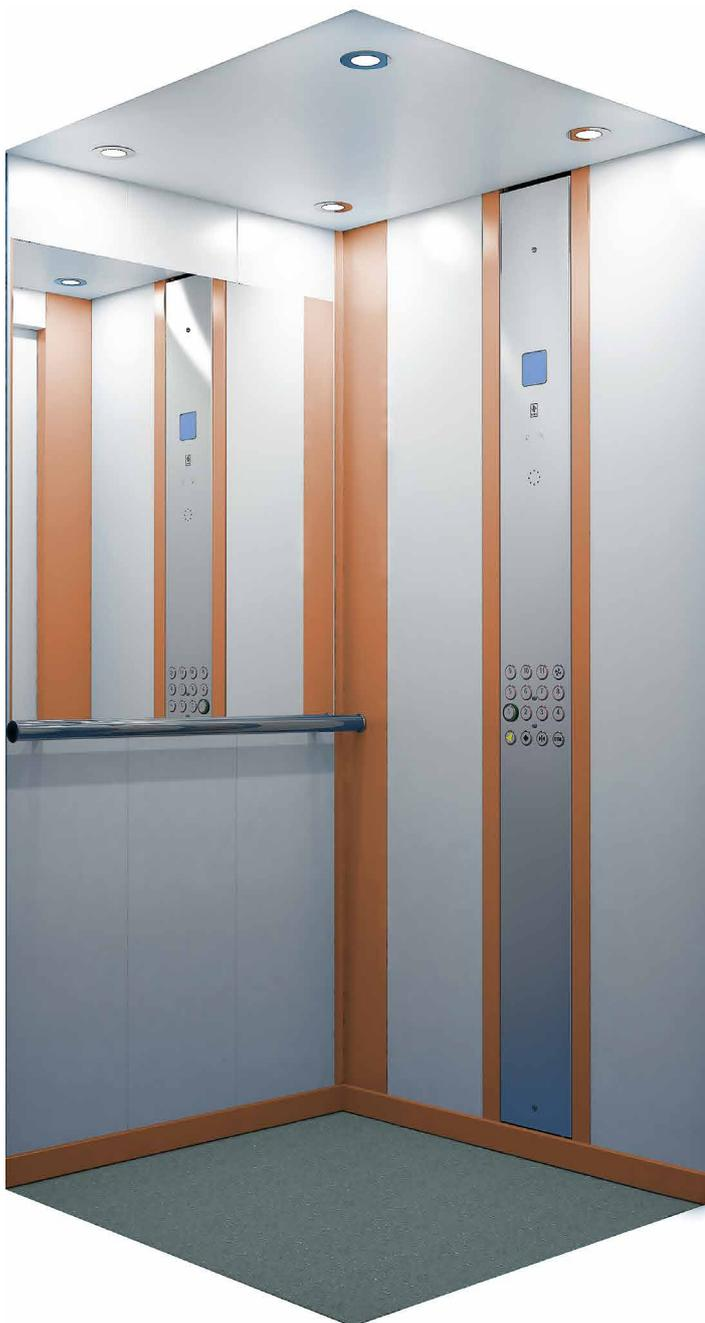
Модель «СИРИУС» в ярком исполнении с контрастной отделкой купе кабины элементами аврорного цвета оснащается вертикальным постом приказов из шлифованной стали, потолочным освещением точечными светодиодными светильниками, удобным хромированным поручнем цилиндрической формы и зеркальным элементом. В отделке пола используется качественный линолеум серых оттенков, устойчивый к загрязнению и истиранию. По запросу модель может быть доукомплектована TFT-дисплеем и речевым информатором.
